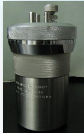
Sistema calorimétrico de combustión isoperibólico modelo Parr 1230 con una bomba estática modelo Parr 101A.
