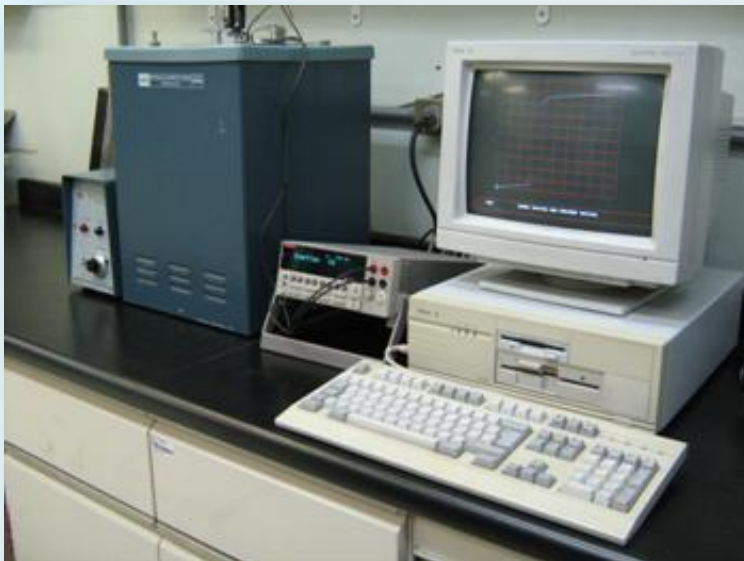
Sistema calorimétrico de combustión isoperibólico modelo Parr 1230 con una bomba estática modelo Parr 101A.
